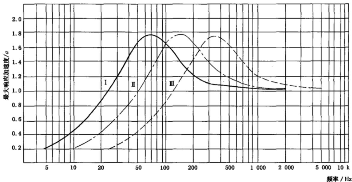
第Ⅰ类 冲击谱系指冲击脉冲持续时间较长,冲击峰值加速度较低时的典型冲击谱。
