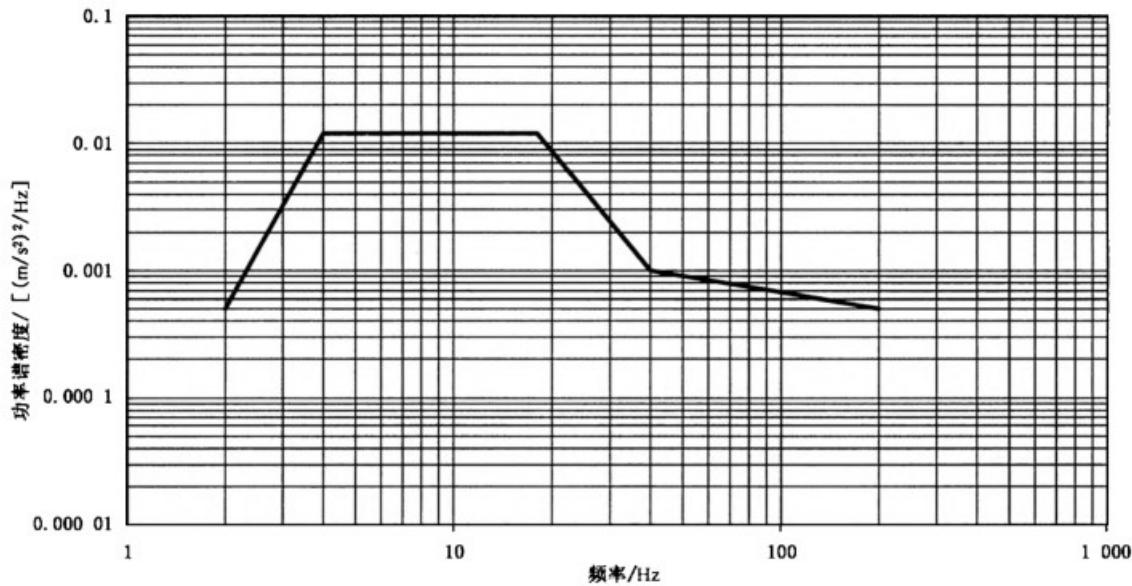
图 A.1 通用运输随机振动 PSD 曲线
