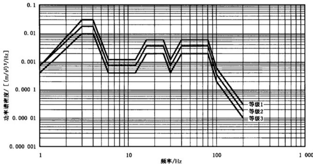
图 C.2 ASTM D 4169-16 车辆随机振动 PSD 曲线
