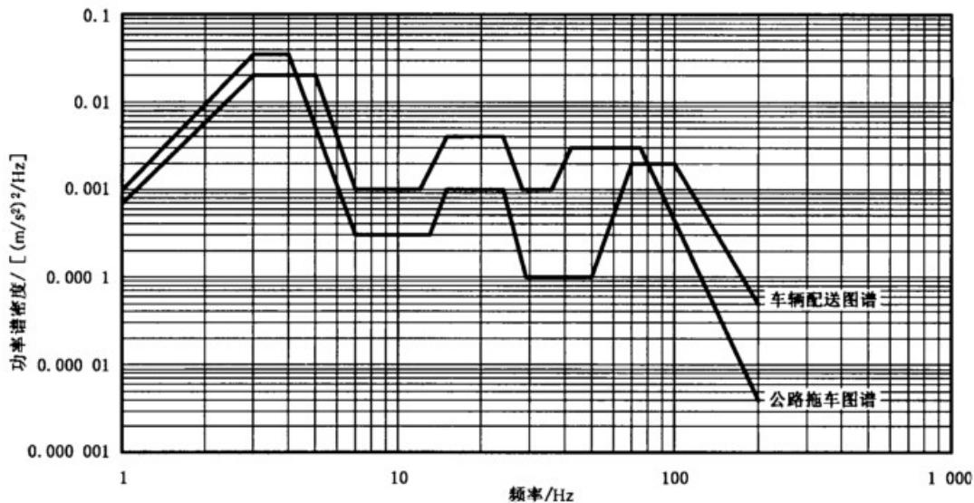
图 C.1 ISTA 3A 车辆随机振动 PSD 曲线
