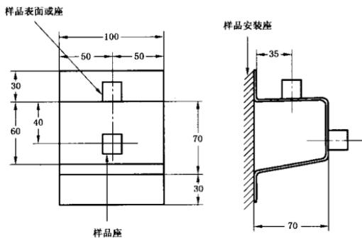
图 D.5 灯座的转换安装
