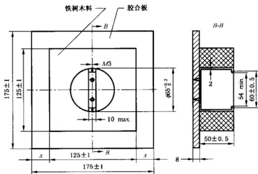
图 D.4 嵌入式开关的转换安装
