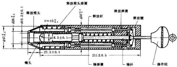
图 E.1 弹簧锤试验装置
